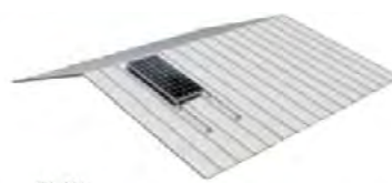
01.1H Disposición de los módulos en horizontal
