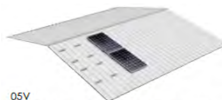
05V Disposición de los módulos en vertical
