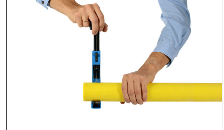
3. Cortar el tubo de forma totalmente recta. Cut the pipe straight.
