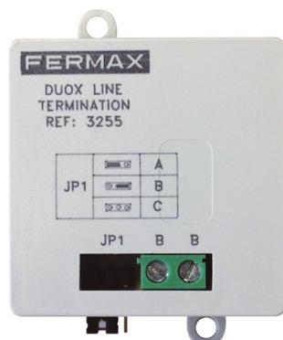
En las instalaciones DUOX es necesario instalar un dispositivo adaptador de línea. Su función es la adaptación de la línea de transmisión. Dispone de un puente para poder realizar diferentes adaptaciones según el tipo de instalación. De reducido tamaño permiten su instalación en registros eléctricos. Se pueden atornillar directamente a la pared.
