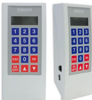
El programador de instalaciones DUOX es un dispositivo, orientado a servicios técnicos e instaladores, que permite verificar el estado de una instalación DUOX.
