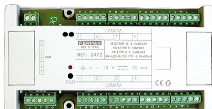
Es posible ampliar las instalaciones de videoportero con cámaras aéreas adicionales. Este dispositivo permite seleccionar y visualizar desde el monitor de la vivienda las diferentes cámaras adicionales instaladas.
