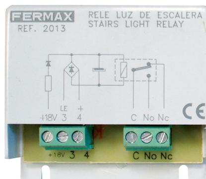
De reducido tamaño permiten su instalación en registros eléctricos. Se pueden empotrar en cajas estándar de 10x10 cm. Disponen de tiras adhesivas para su fijación, o bien, se pueden atornillar directamente a la pared. Necesario para activar un dispositivo externo (luz de cortesía, segunda puerta, etc) desde el botón correspondiente (botón adicional) situado en el teléfono o monitor.
