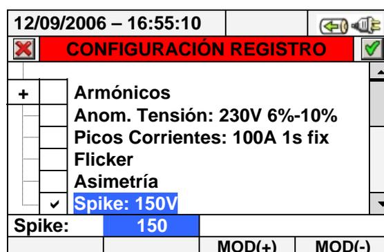
Fig. 111: Pantalla Spike - configuración parámetro
