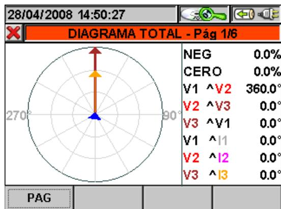
Fig. 167: Diagrama vectorial total en un Sistema Trifásico 4 hilos
