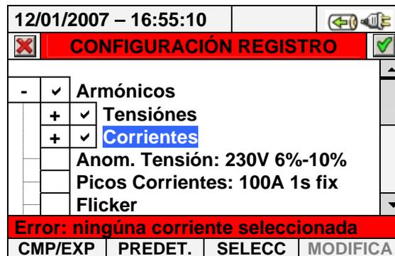
Fig. 101: Pantalla ninguna corriente seleccionada
