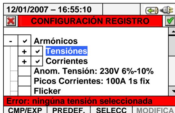
Fig. 102: Pantalla ninguna tensión seleccionada
